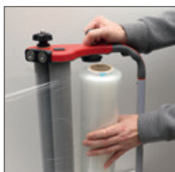
Folienhalterung hochziehen, Rolle einlegen ...
