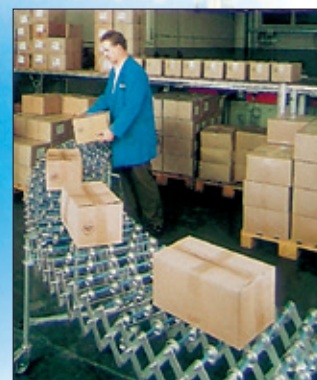
Scherenrollen- und Scheren-Röllchenbahnen als eigenständige, flexible Förderstrecken
