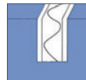
Kombiverstärkt mit 2 Längsfäden und einem Kurvenfaden
