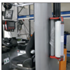
Mit Hilfe der Magnete hält der Abroller sicher an einem Gabelstapler ...
