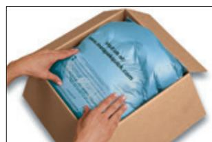
Einen zweiten Beutel aktivieren und oben auf das Produkt legen. Die Kartondeckelung schließen, so dass der Schaum sich zu einem Oberpolster ausdehnt.
