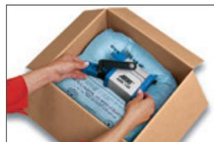
Sobald der Schaum anfängt sich auszudehnen, das zu verpackende Produkt auf den Mittelpunkt ausrichten und in Position halten, bis es vom Schaum gestützt wird.
