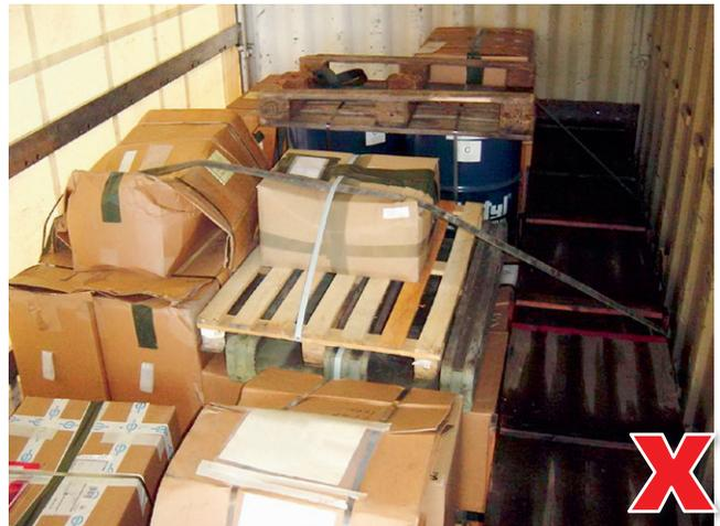
Kartons bieten zu wenig Festigkeit zum Niederzurren. Hier sollten die Ladeeinheiten besser mit Stretchfolie bzw. Umreifungsband gesichert werden.
