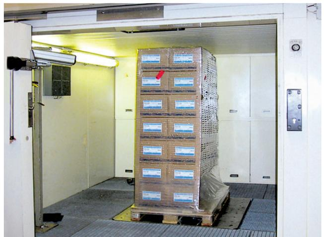
Simulation von Schwingungen und klimatischen Belastungen, wie sie z. B. bei Überseetransporten und während des Umschlags auftreten
