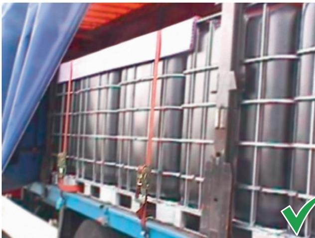
Die Gitter der IBC's werden durch einen Langwinkel geschützt. Die Vorspannkraft verteilt sich optimal auf die gesamte Länge.
