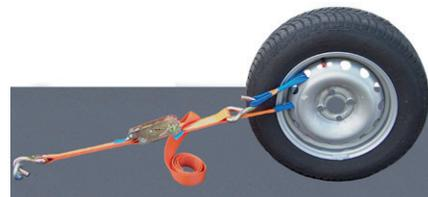
Sicherung von ungefederter Masse für Fahrzeuge mit Alufelgen.
