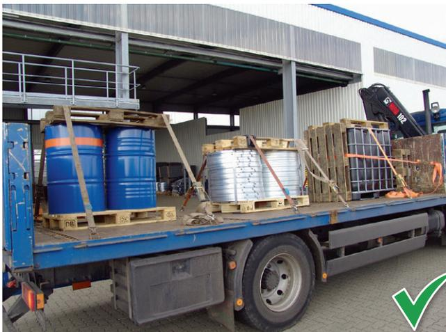
Unterschiedliche Zurrmethoden. Hier: Niederrurren und Kopflashing.
