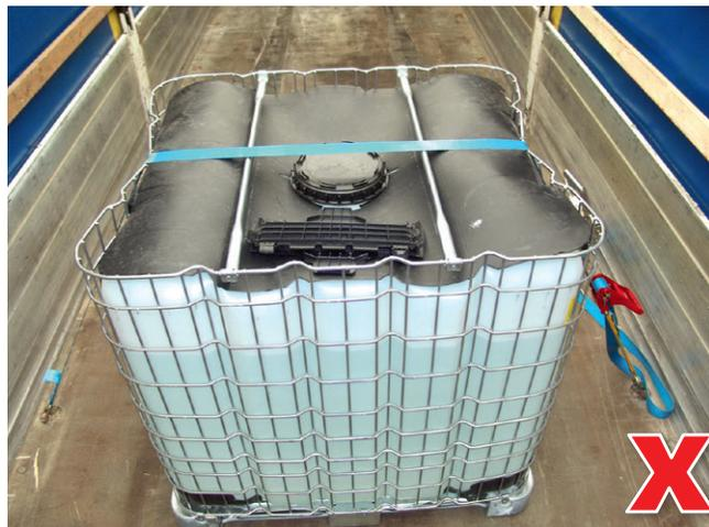
Die Gitter der IBC's werden durch die Vorspannkraft des Zurrmittels beschädigt. Die Bruchfestigkeit des Zurrmittels wird durch scharfe Kanten gefährdet.
