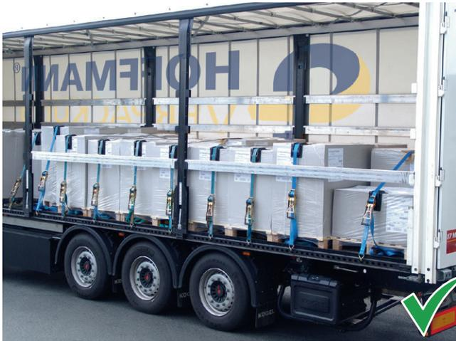
Palettiertes Formatpapier mit Kantenschutzwinkeln im richtigen Winkel niedergezurrt.
