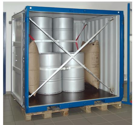
Absicherung zur Containertür mit Lashingband und Spitzhaken
