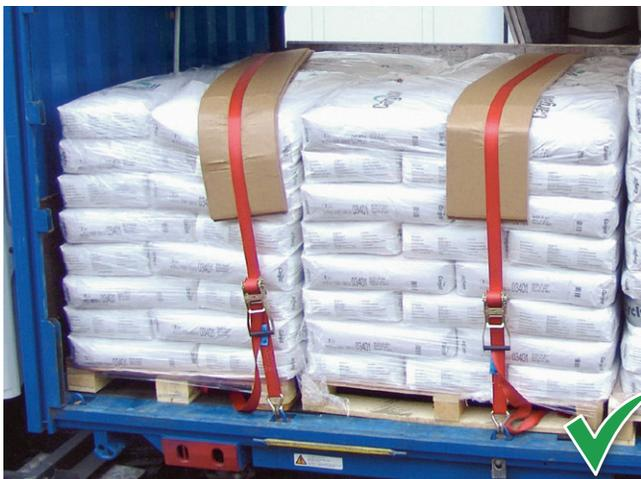
Der Anpressdruck wird über die hochfeste Wellpappe gut auf das Ladegut verteilt. Die Säcke bleiben unbeschädigt.
