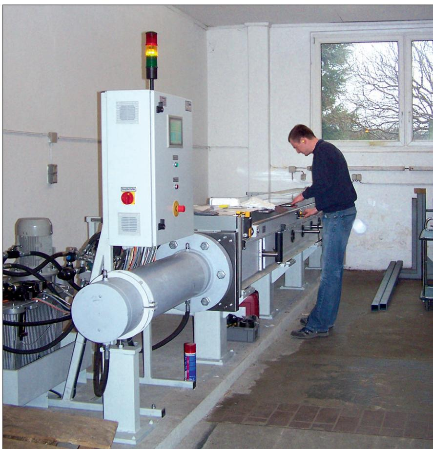
50 Tonnen-Prüfmaschine für Zurrgurte
