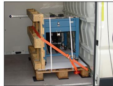
Verpackungsmaschine mit 2-teiligem Zurrurt befestigt
