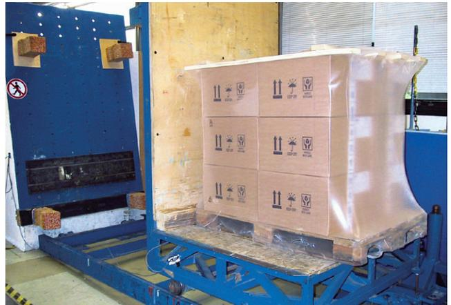
Simulation von Stößen und deren Auswirkung auf die Ladeeinheitensicherung und das Ladegut
