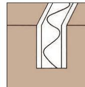
Kombiverstärkt mit 2 Längsfäden und einem Kurvenfaden
