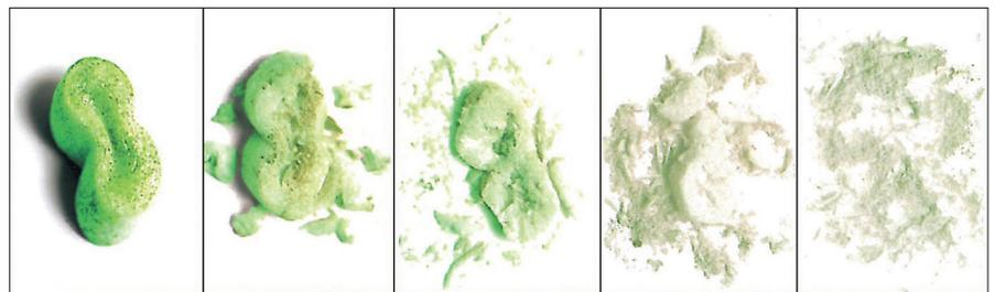
flo-pak® GREEN wird durch Microorganismen abgebaut
